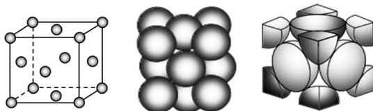
铜晶体面心立方晶胞及其切割示意图
